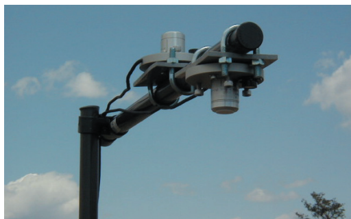
写真1 光量子センサーを上下に設置し、可視光の反射率を計測
