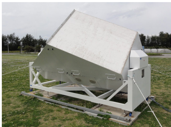
写真1: 斜め上方へ向けた Ka レーダの外観。三角形のレドームの中にアンテナが二つ入っています。
