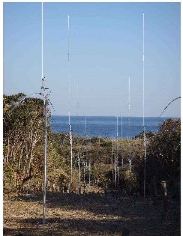
写真 1 : 対馬に設置した遠距離海洋レーダの受信アンテナ列。
