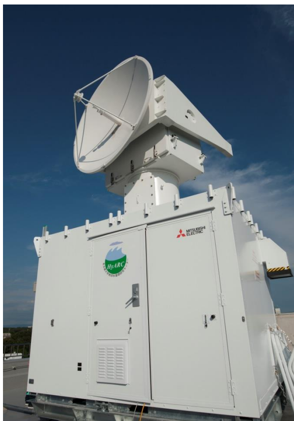
写真1: 環境共用館屋上に設置された雲レーダ。
