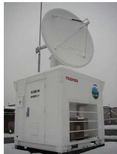
2007 年 11 月に地球水循環研究センター屋上に設置されたマルチパラメータ (MP) レーダ。
