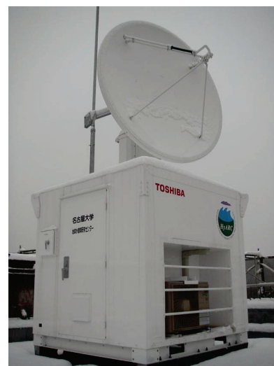
2007 年 11 月に地球水循環研究センター屋上に設置されたマルチパラメータ（MP）レーダ。
