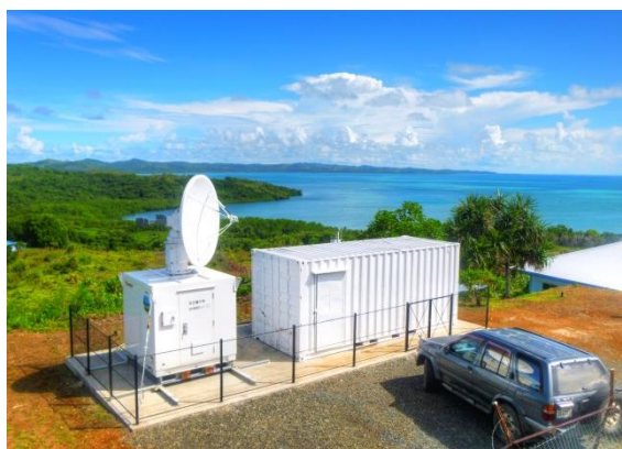
パラオ共和国ガラrong州に設置された名古屋大学 X バンド偏波ドップラーレーダ。2013 年 6 月に海洋研究開発機構との共同観測を実施した。
