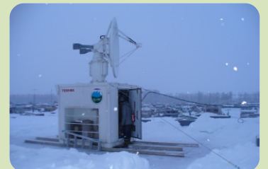
北海道東部陸別町でのマルチパラメータレーダによる降雪の観測
