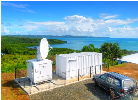
パラオ共和国ガラング州に設置されたマルチパラメータレーダ。2013年6月に海洋研究開発機構との共同観測を実施した。
