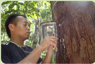
幹の中の水の流れ（樹液流速度）を測定するセンサーの設置
